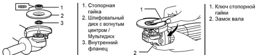
При эксплуатации инструмента с диском с углубленным центром/многофункциональным диском всегда используйте поставляемое с инструментом ограждение. Во время работы диск может разрушиться, и ограждение помогает снизить риск получения травмы.
