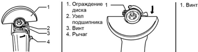
Ослабьте винт, и затем рычаг на ограждении диска. Установите защитный кожух так, чтобы выступ на его хомуте совместился с пазом на коробке подшипника. Затем поверните ограждение диска по кругу и установите его в положение, показанное на рисунке. Затяните рычаг для
